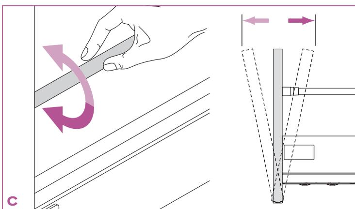
**C >** Ajustez l'inclinaison de la façade du bloc coulissant en tournant la barre de retenue vers la gauche ou vers la droite pour basculer le bandeau vers l'avant ou l'arrière.
