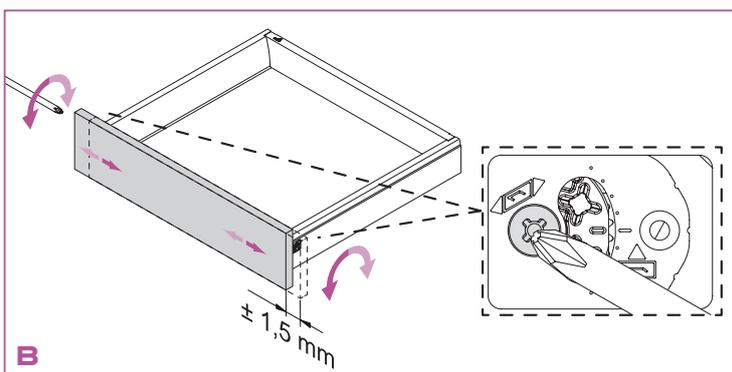
**B >** Réglez au niveau latéral en tournant la vis des deux côtés  $\pm 1,5 \text{ mm}$ .
