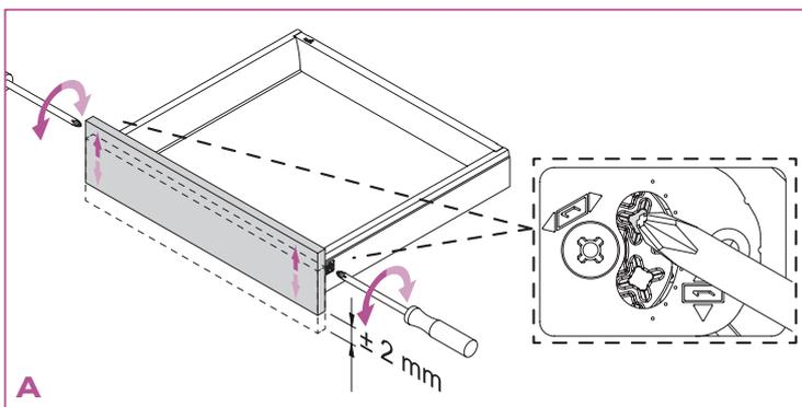
**A >** Réglez en hauteur en tournant la vis des deux côtés  $\pm 2 \text{ mm}$ .
